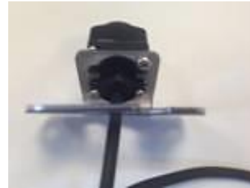
Telecamera ruotata di 180° in fase di installazione
